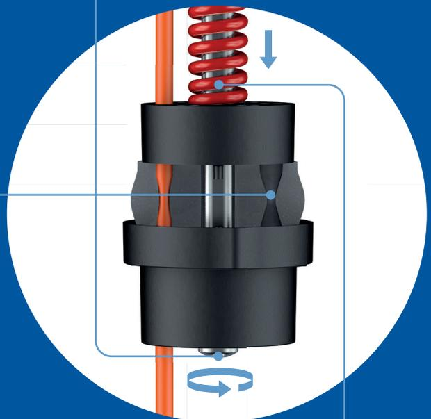
... wird Dichtelement verpresst
