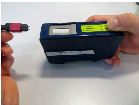
1. Le type de cassette est à choisir selon le connecteur correspondant (Mâle ou Femelle).
