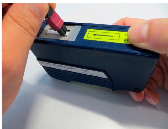
2. Frotter le connecteur dans le sens de la flèche sur la bande.
