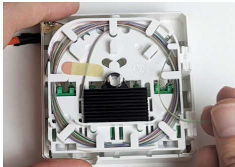
5G Fasern unter den Niederhalter einlegen.
