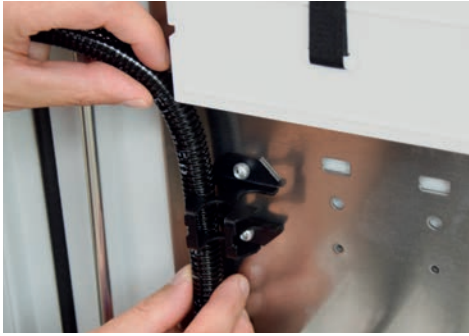
3E Flexschlauch unterhalb des Mixers in Halterung positionieren.
