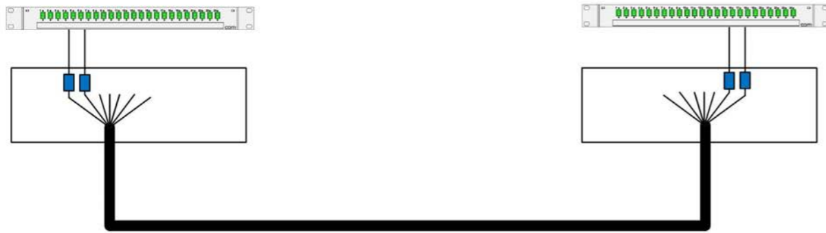
Cablage primaire avec connexion directe
