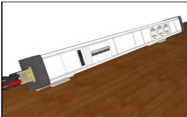
Geräteinstallation in einem Installationsprofil mit 45mm EinbaufORMAT. Die Montage erfolgt werkzeuglos, durch Einklicken der Geräte.
