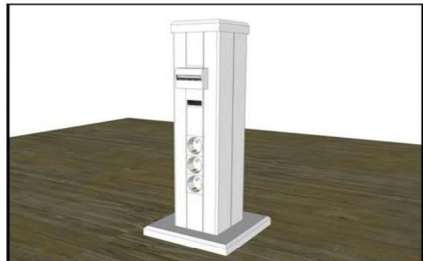
Switchinstallation in einer Kommunikationssäule in Kombination mit 45mm EinbaufORMAT. Der Switchkopf wird dabei in vertikaler Position montiert, um bestmögliche Patchkabelführung zu gewährleisten.
